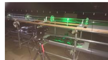
PIVによる流れの可視化実験
