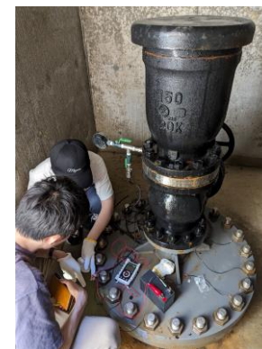
佐渡島における圧力計測実験
