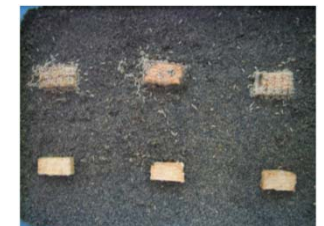
木材腐朽菌により腐った部分を忌避するヤマトシロアリ 上:野外より採取した材の健全部 下:野外より採取した材の腐朽部
