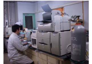
イオンクロマトグラフによる糖およびエタノールの分析
